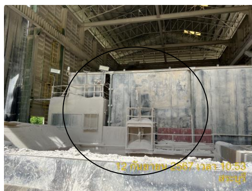
รูปที่ 10 ระบบกำจัดฝุ่นแบบ Dust Filter ในโรงโม่หินและระบบสเปรย์น้ำ
